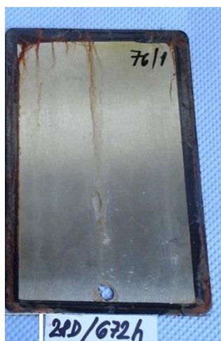
Vzorek 24 0076/1 po 672 hodinách v solné mlze
