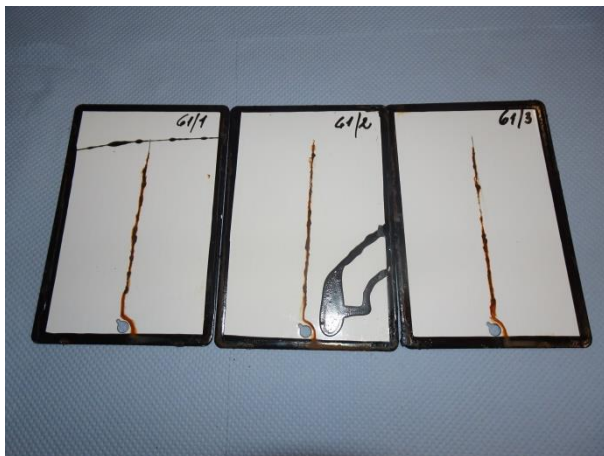
Vzorek 24 0061 po 168 hodinách v solné mlze
