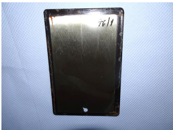
Vzorek 24 0076/1 po 168 hodinách v solné mlze
